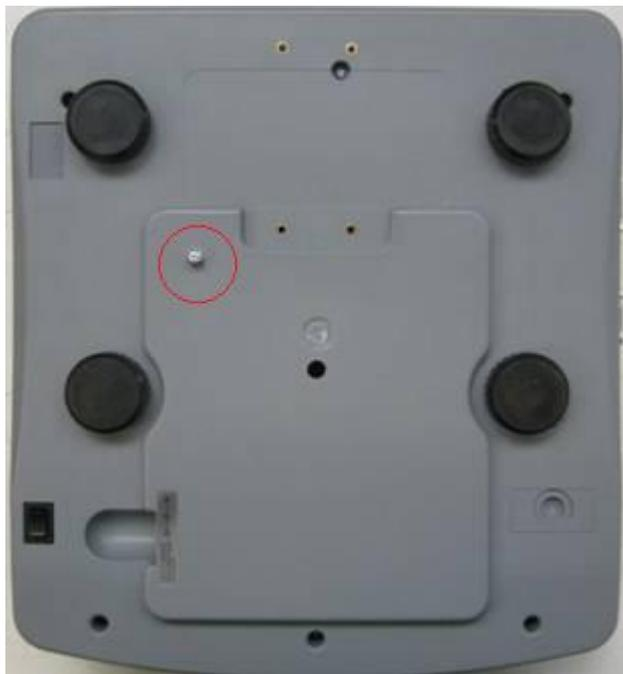
**c) Nivelez la plate-forme** en tournant les pieds à vis jusqu'à ce que le niveau à bulle positionné sous le plateau soit au centre. La stabilité de la plate-forme est très importante.
